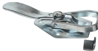
1307 Flaklås, galvat med låsögla. Låset säkras i låst läge med fjäderbelastad spärrhake med låsögla. Plattans längd 130 mm och bredd 90 mm. Totallängd 210 mm. Levereras utan svetsbygel.
