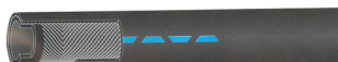
2400T.08 Allroundslang för diesel, mineraloljor och fetter samt tryckluft (OBS! ej bensin). NBR. Temperaturområde -25° till +100°C. Märkning HYDRO K (OL15045). Oljeslang 8x3,5 mm.
