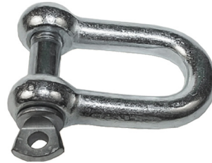
1053 Galvaniserade Schackel 3/8 för stagning och förankring. Öppning: 20 mm. Invändig: 40 mm. Diameter: 10 mm. Vikt: 0,134 kg.
